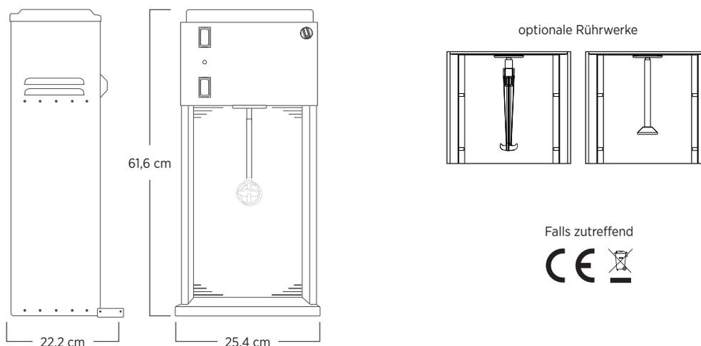
Umfasst Mix'n Machine Advance mit Softeis-Rührwerk für permanentes Rühren.
